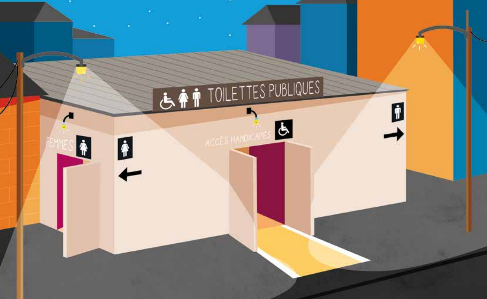
Figure 1 : Exemple de l'extérieur d'un bâtiment sanitaire adapté aux femmes et aux filles.
