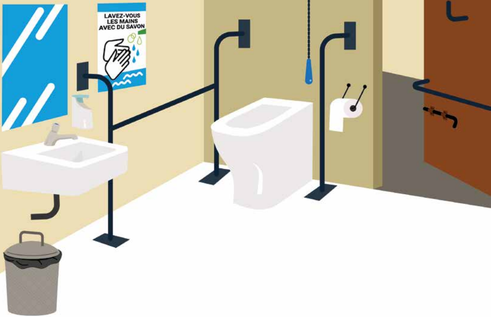
Figure 4 : Exemple de l'intérieur d'une cabine de toilette adaptée aux femmes et aux filles et accessible aux personnes à mobilité réduite.
